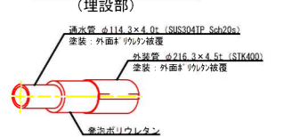
管梁詳細図 Noscale (埋設部)
