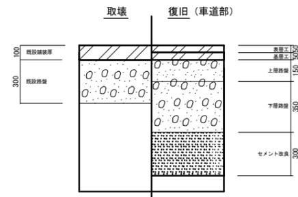
※アスファルト撤去厚=既設舗装厚+10mmとする
