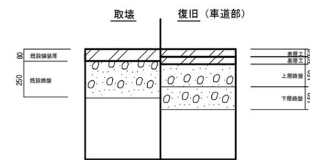
※アスファルト撤去厚=既設舗装厚+10mmとする
