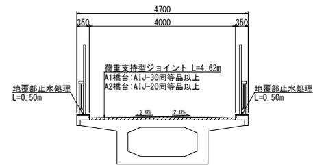
地覆部止水処理詳細図 S=1:10, 1:2
