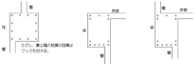
図2.1 末端部にフックを必要とする出隅部の鉄筋（●印）
