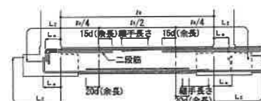
図5.2 主筋の継手、定着及び余長 (その1)
