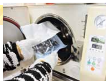
高圧蒸気滅菌器による滅菌作業
