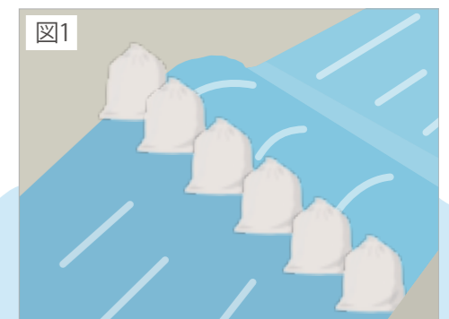
図1 土のうによる洪水吐のかさ上げは、ため池機能を阻害するため危険です。
