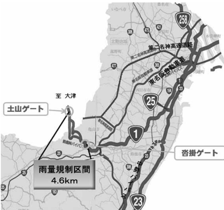
三重河川国道事務所が管理する国道1号鈴鹿峠(亀山市関町沓掛から甲賀市土山町山中までの全長4.6km)では、大雨による土砂崩れや落石のおそれがある場合、通行者を危険から守るため、降り始めからの降雨量(連続雨量)が180mmに達した時点で事前通行規制(通行止め)を実施します。
