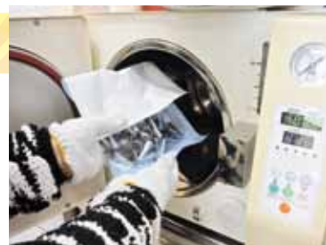
高圧蒸気滅菌器による滅菌作業
