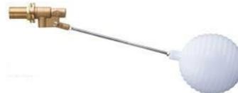
複式:浮玉が水位下降により下がった時に弁も浮玉の下がる重みで開く構造であり、開閉は確実にこなされるが、構造も複雑である。
