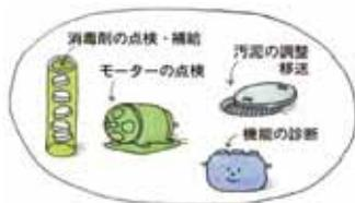
浄化槽の機能を良好な状態で維持できるように、汚泥（微生物）や機器の点検、調整などを行います（家庭用では年3～4回）。
