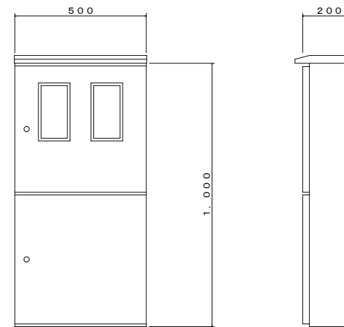
引込開閉器盤 S=1:10 (ステンレス製)
