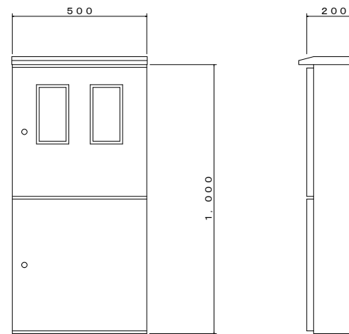
引込開閉器盤 S=1:10 (ステンレス製)
