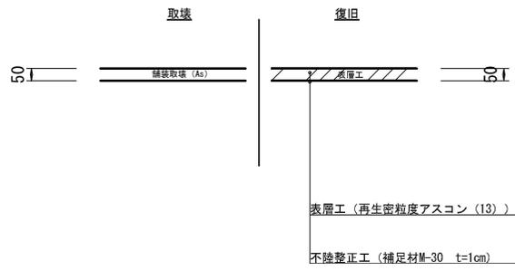
雨水・汚水マンホール蓋修繕工法図
