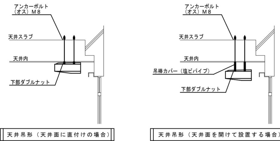
天井ボードと室内機・壁と室内機は可能な限り隙間がないように設置すること
