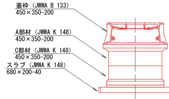
空気弁・消火栓工法図
