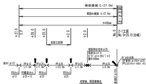
2-2工区 (仮設工) PPφ25mm 露出配管
