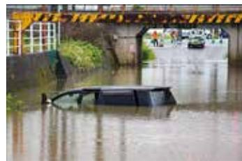
アンダーパスなどに車が水没した場合、車外の水位がドアの高さの半分を超えると水圧でドアを開けることができなくなります。脱出ハンマーなどを手の届く所に常備しておきましょう。
